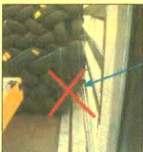
Nach schräg außen nur linienförmig an den Einsteckprofilen anliegende Reifen sind in der Lagenbildung zwingend zu vermeiden.
